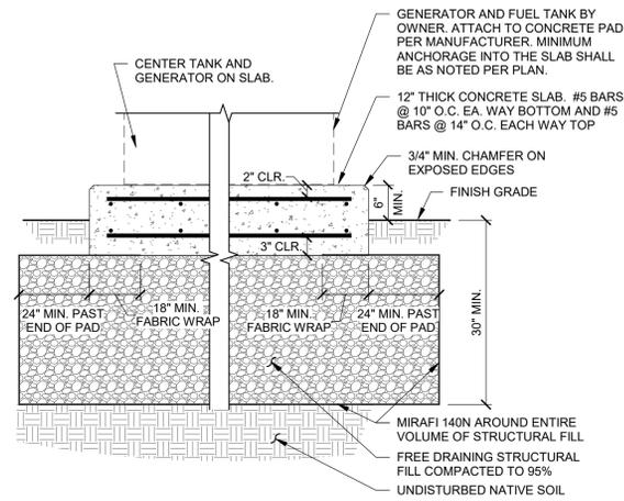
**12 GENERATOR AND FUEL TANK SLAB**
