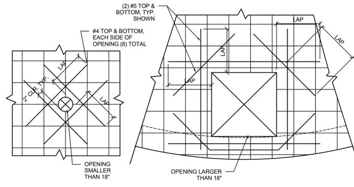
**7 SLAB REINFORCING AT SLAB OPENINGS**
