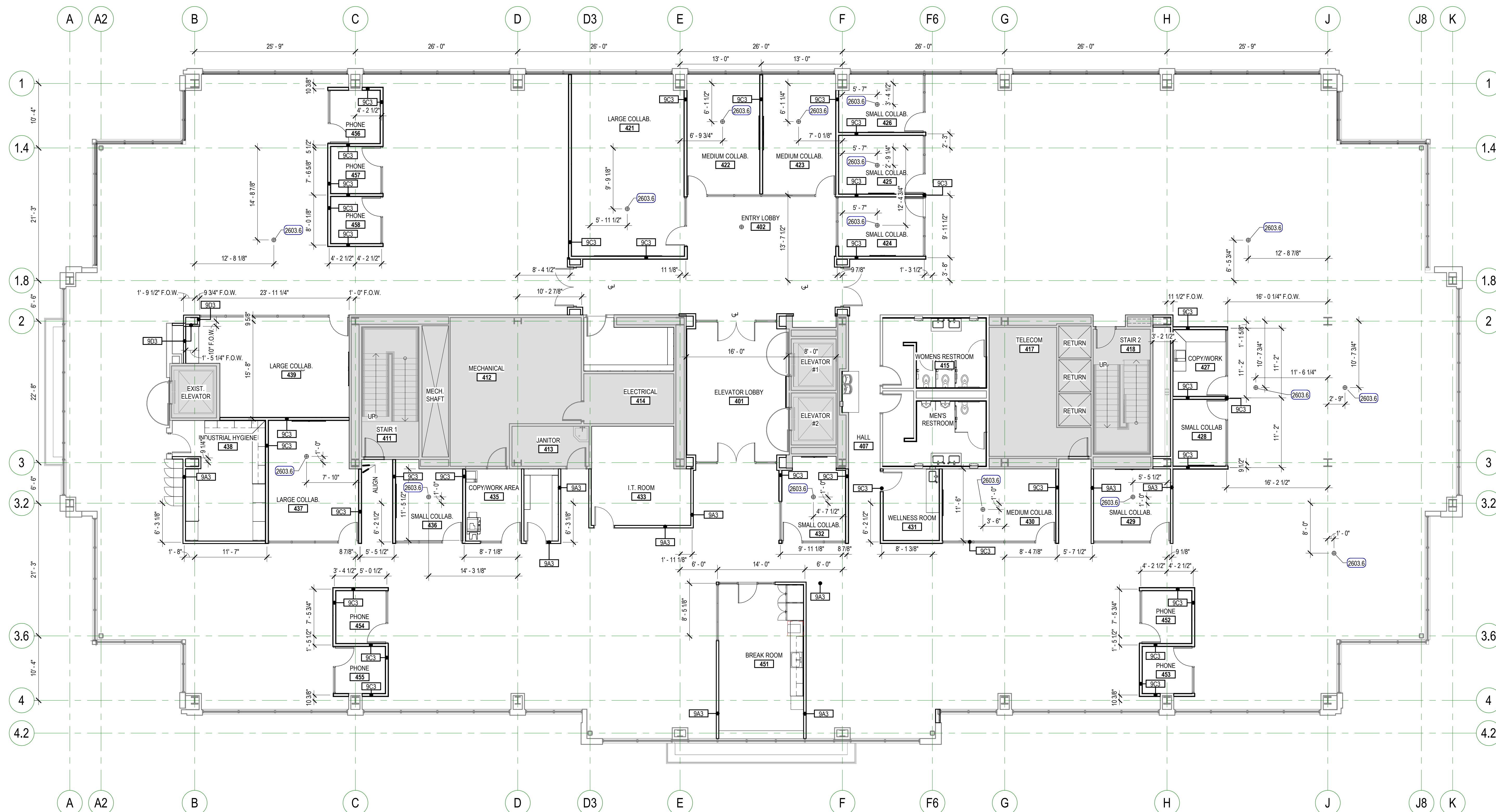
A1 PLAN - LEVEL 04 - DIMENSION + WALL TYPE SCALE: 1/8" = 1'-0"
