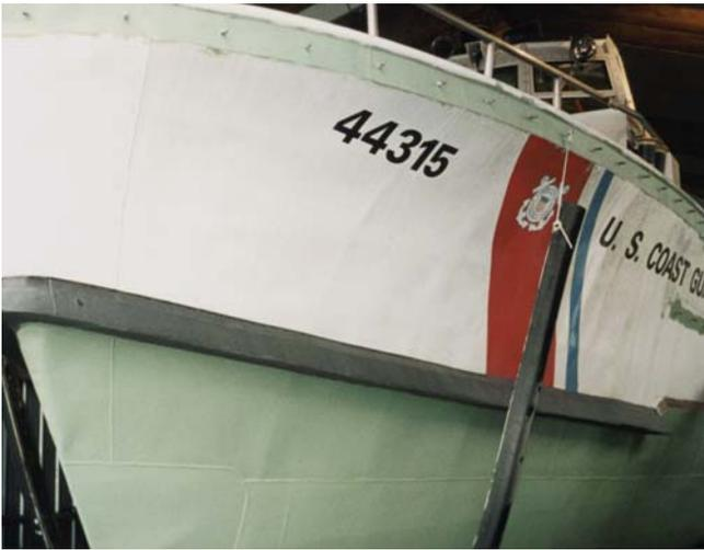
*El destacamento de la Guardia Costera de los E.E.U.U. utiliza el sistema de ráfagas de esponjas abrasivas **Sponge Blasting™**, de **Sponge-Jet®**, para eliminar pintura y contaminantes en las superficies de sus Botes Patrulleros, ya que es un medio seco, reutilizable y que produce bajos niveles de polvo residual.*
