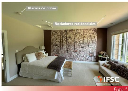
En general, en edificios, los detectores de humo se requieren también en el lobby de un elevador para sacarlo de servicio durante un incendio (*elevator recall*); en el sistema de aire acondicionado centralizado para evitar que este sistema distribuya el humo del incendio; en ciertos cuartos importantes, como el centro de cómputo o de comunicaciones, con la función de detectar incendios de muy baja energía y para que puedan ac-
