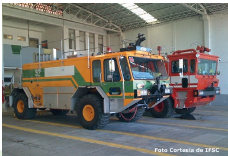
CAMIONES DE RESCATE Y COMBATE DE INCENDIOS EN AERONAVES (ARFF) QUE SE CARACTERIZAN POR SU GRAN VELOCIDAD DE RESPUESTA
