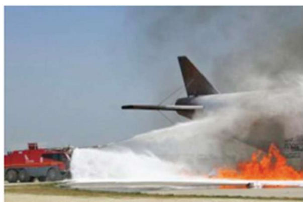
Camiones de Rescate y Combate de Incendios en Aeronaves (ARFF) que se caracterizan por su gran velocidad de respuesta y aplicación inmediata de espumas AFFF.
