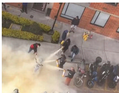
Incendio en la batería eléctrica de una motocicleta eléctrica tipo "scooter", que finalmente se pudo extinguir después de aplicar aproximadamente 20 extintores, principalmente de 10 lbs de PQS (Foto cortesía Fire Protection Institute).
