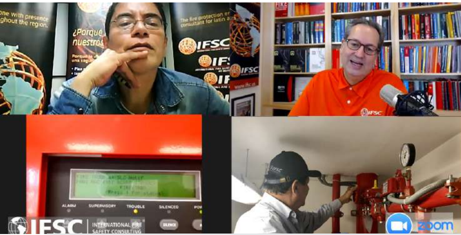
Imagen 1. A través de una plataforma de videoconferencia, la IRV permite que los ingenieros que lideran el proceso de inspección o aceptación se comuniquen en línea con los contratistas y los dirijan durante la prueba de aceptación de los sistemas
