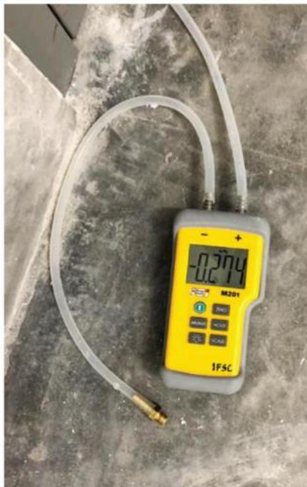
Equipo de prueba de presurización, mostrando la diferencia de presión entre el corredor y la escalera (Foto Cortesía de IFSC).
