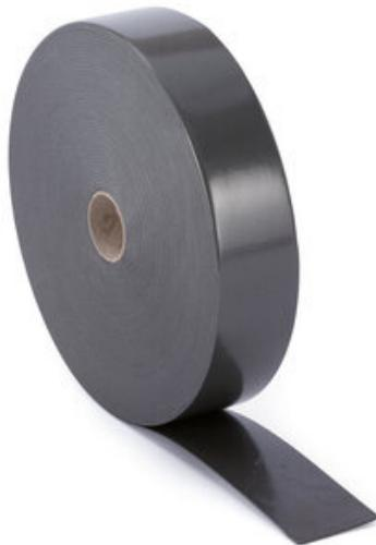
重疊自動黏合帶 Impactodan 由交聯聚乙烯泡棉組成，厚 3 毫米，寬 70 毫米。在安裝 Impactodan 的甲板解決方案時，它被用作輔助產品。它確保 Impactodan 輓之間正確重疊，避免可能降低絕緣效率的聲學短路。
