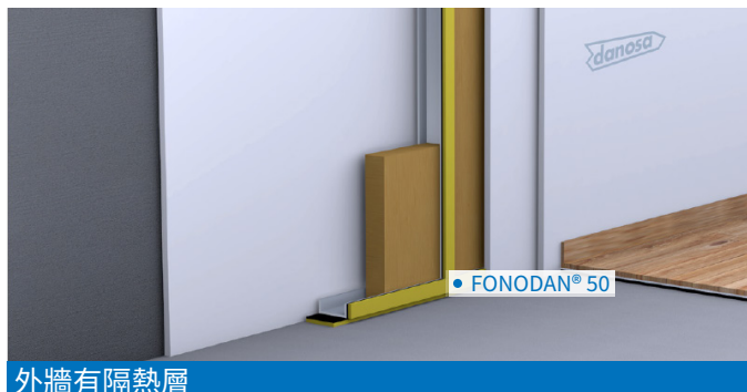
外牆有隔熱層
