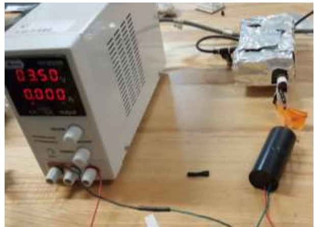
Ilustración 20 . Vista de la mini fuente de rayos X conectada y en operación.
