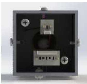
Ilustración 8 Vista de la tapa posterior con los conectores (elaboración propia).
