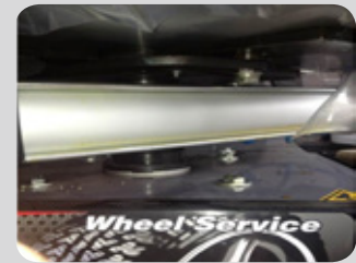
Drehtellerzylinder mit bis zu 360 kg Klemmkraft.
