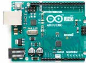
Figura 3. Placa Arduino UNO. Fuente: AG Electrónica
