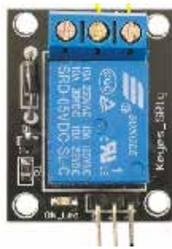
**Figura 4.** Módulo de Relevador para Arduino.
