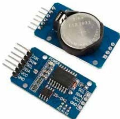
Figura 2. Módulo RTC para Arduino
