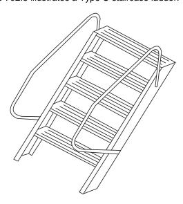
FIGURE 702.3 TYPICAL STAIRCASE LADDER, TYPE C
