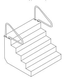
FIGURE 702.5 TYPICAL IN-POOL STAIRCASE, TYPES E AND F
