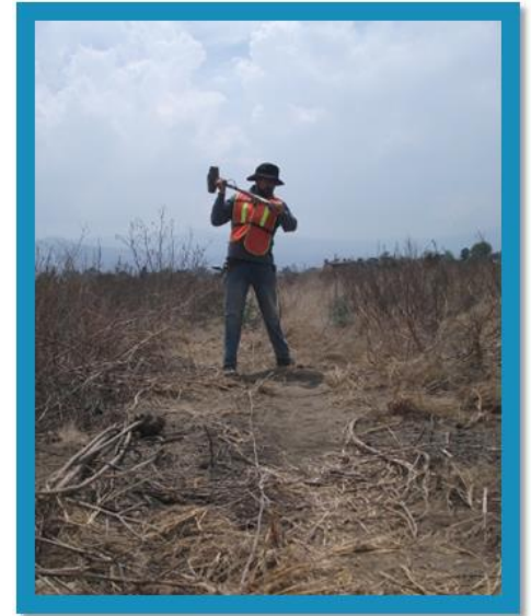
Fotografía 3. Fuente activa, generador de ondas.
