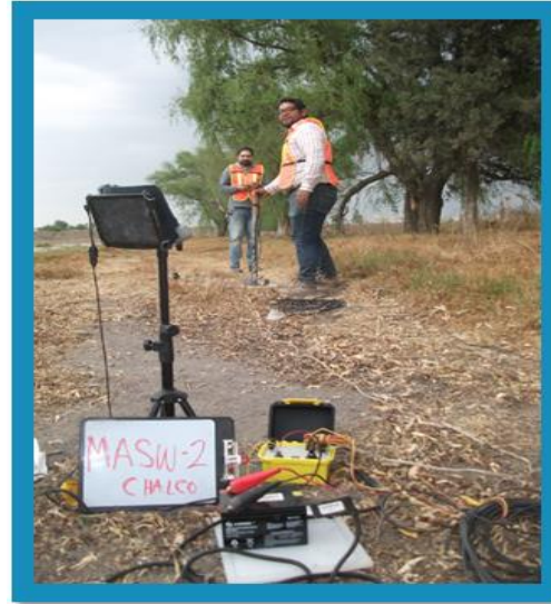
Fotografía 2. Aplicación del método MASW.
