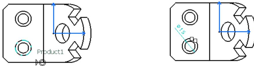
Ilustración 693: Tipo de cota *Diameter Dimensions*.
