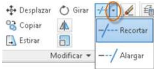
En la siguiente ilustración, se desea alargar las líneas que representan los pasos de esta plataforma. Inicie el comando Alarga, seleccione el contorno y, a continuación, pulse Intro o la barra espaciadora.
