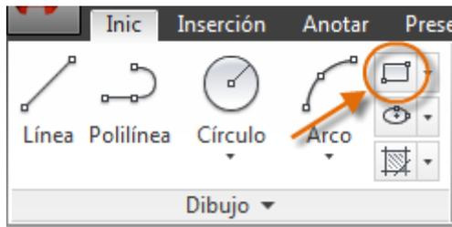
Solo debe hacer clic en dos puntos diagonales del rectángulo, como se muestra en la ilustración. Si utiliza este método, active la referencia a rejilla (F9) para conseguir precisión.
