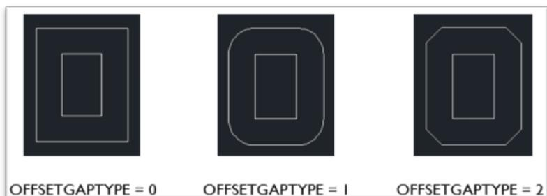
Figura 4.18. Utilización del comando OFFSETGAPTYPE.
