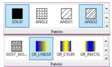
Figura 8.4. Controles para la creación y edición de patrones / degradados (Patrón).
