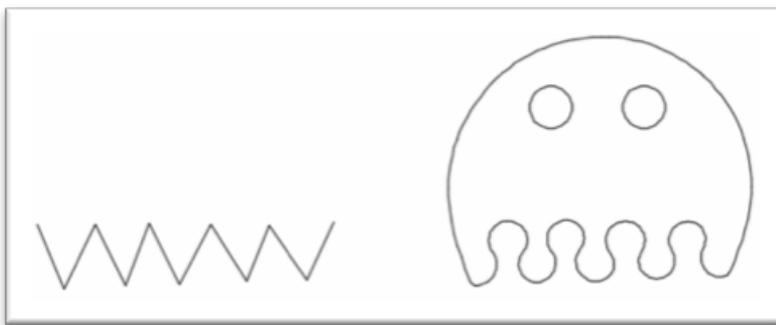
Figura 4.41. Dibujo a través de los comandos polilínea, editpol y círculo.
