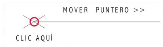
Figura 12.1: Cómo dibujar usando la Entrada de Distancia Directa.
