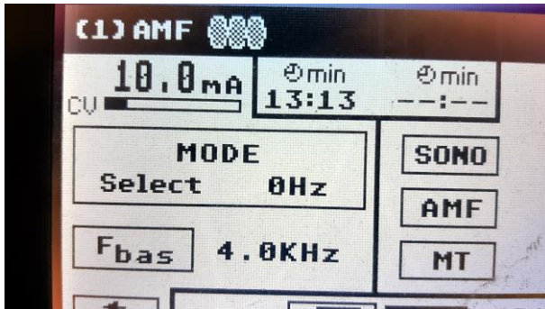
Figura 18.- Ajuste de la portadora de 4 KHz, con modulación a 0Hz, en modo VC y a 10 mA de pico.
