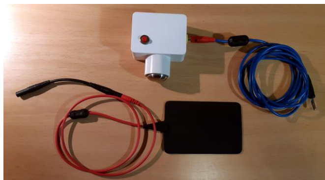
Figura 16.- Conjunto de electrodos para mediciones de conductividad e impedancia corporal usando electrodo metálico con presión regulada.
