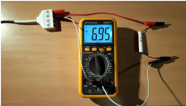
Figura 17.- Polímetro midiendo intensidad en rango de 20 mA y AC.
