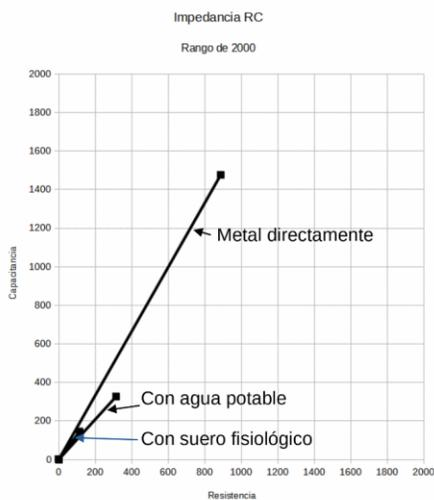
Figura.- 8 Representación gráfica de las tres medidas en una gráfica con rango máximo de 2.000 Ω.
