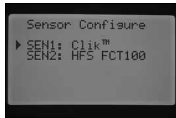
SEN 1 - SENSOR TIPO CLIK SEN 2 - SENSOR DE CAUDAL (HFS FCT100)
