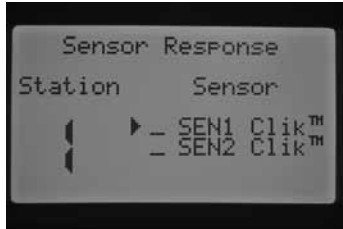
Ningún sensor programado para la Estación 1
