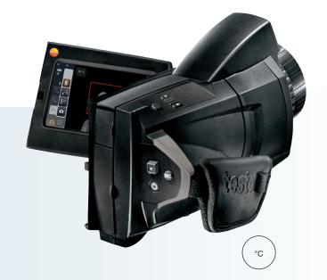
Con la cámara termográfica testo 890 pueden medirse rápida y fiablemente las temperaturas superficiales corporales de diversas personas en instalaciones fuertemente concurridas tales como aeropuertos, estaciones de tren o centros comerciales.
