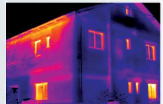
**Detección de las pérdidas de energía en edificios:** Detección e ilustración inmediatas de puentes térmicos en fachadas o en el edificio.
