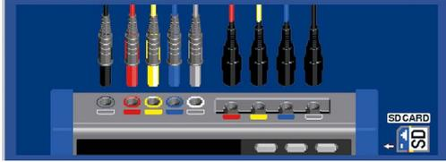
**PASO 2** Conecte los cables de voltaje y los sensores de corriente al circuito a medir.
