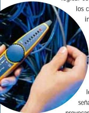
aislar rápidamente el cable correcto en un grupo enmarañado o en un patch panel. IntelliTone elimina horas de confusión con el cable, para que pueda acceder al correcto la primera vez.
