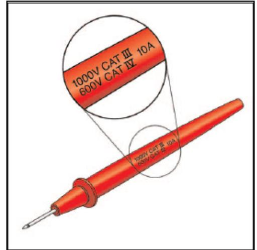
Asegúrese de que tanto el MD como los conductores de prueba estén marcados de manera clara con su clasificación de seguridad. Si los conductores de prueba del MD no igualan o exceden la clasificación del probador, entonces está poniendo el probador, y lo más importante, su salud en riesgo.
