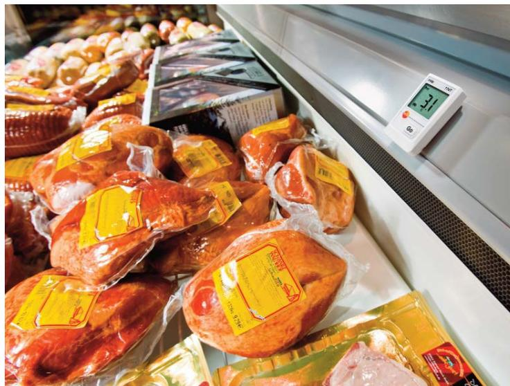
El mini datalogger testo 174T es el ideal para el monitoreo de temperatura en refrigeradores, freezers, salas de conserva y estanterías refrigeradas.
