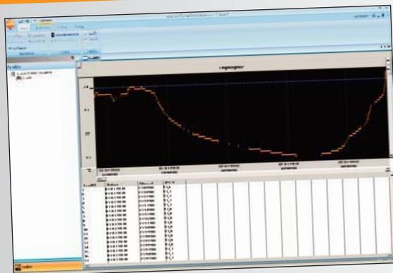
Con el nuevo software testo ComSoft Basic puede programar y descargar los datos del logger mediante la interfase USB. Los datos de medición pueden analizarse intuitivamente.
