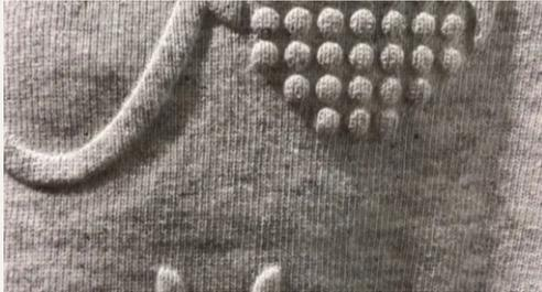
Embossed eignet sich nicht bei kleinen Auflagen, da die Herstellung der Metallstanzform kostenintensiv ist. Die Stanzform kann natürlich immer wieder verwendet werden. Einmal hergestellt kann sie 1000fach verwendet werden.
