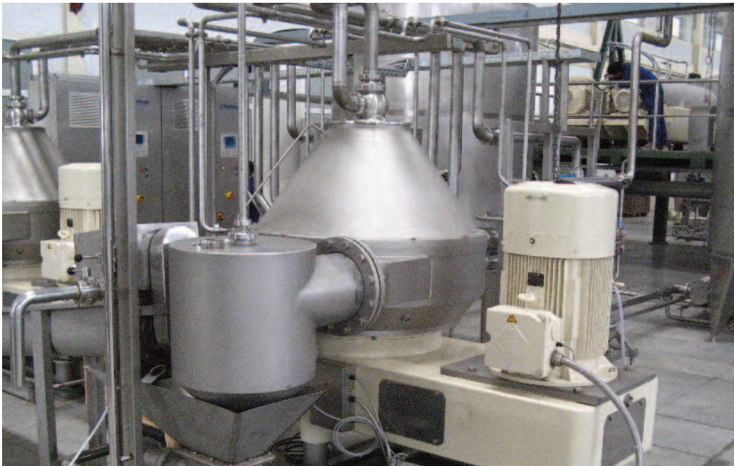
En caso de procesos de separación que se realizan en diferentes etapas: Óptima adaptación a otros sistemas de separación, como por ejemplo centrifugas decantadoras, prensas banda etc.
