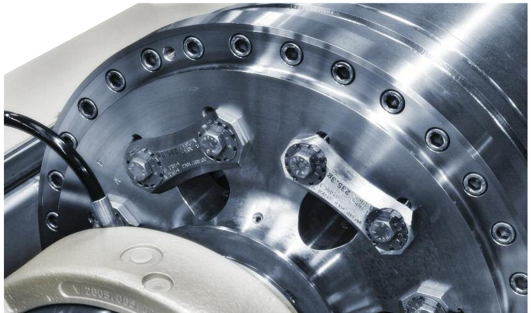
Rotor del decanter con placas de regulación ajustables
