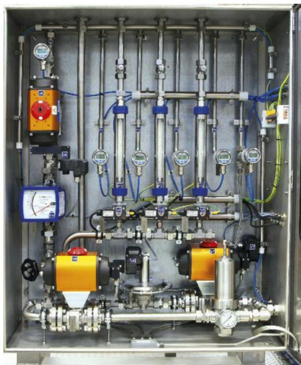
Unidad de Control Flottweg para la alimentación y la purga con gas inerte
