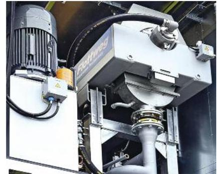
Decanter Flottweg Z4E para el procesamiento de lodos de perforación
