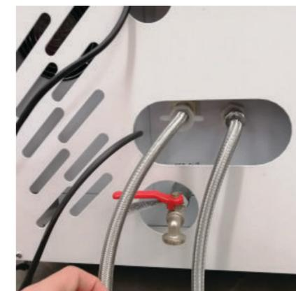
TUBERÍA PARA CARGA Y DESCARGA DE LÍQUIDO SANITIZANTE
