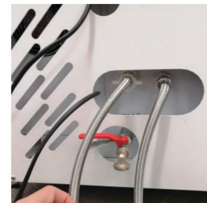
TUBERÍA PARA CARGA Y DESCARGA DE LIQUIDO SANITIZANTE
