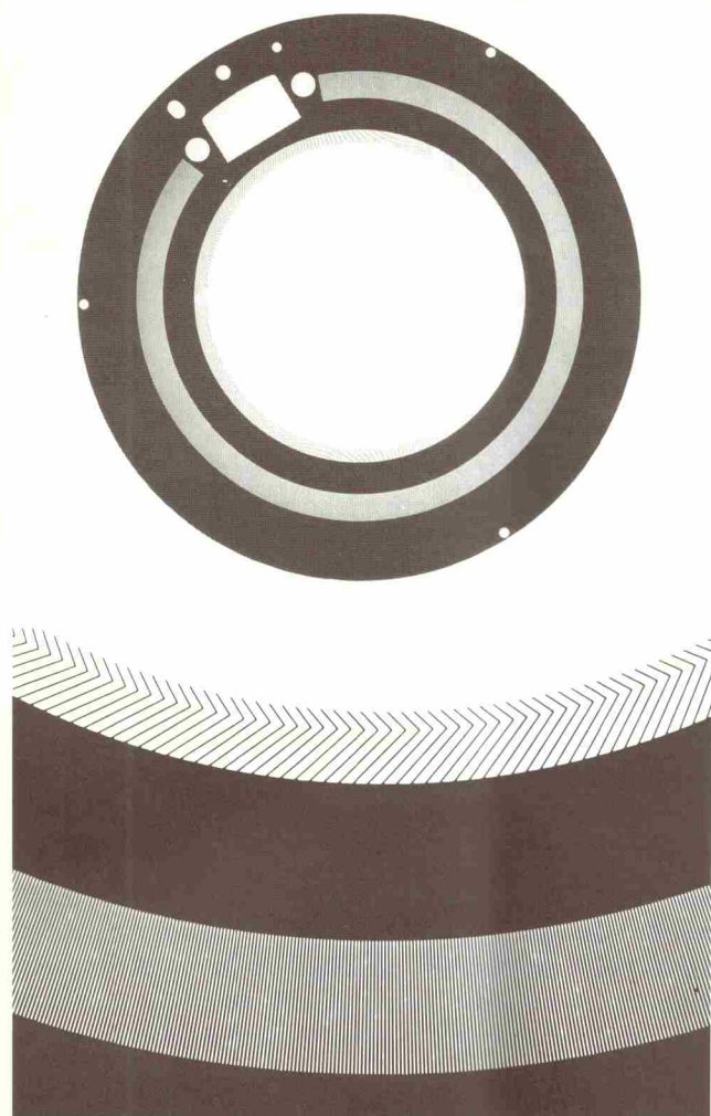
Fig. 3. Een schijf van de azimuthselector. De uitvergroting toont de smalle spleten ( 60\ \mu\text{m} breed) en veertjes voor de centrering van de schijf.
