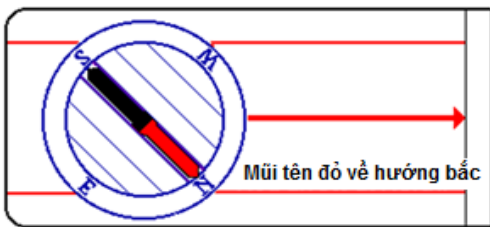
Hình 4- Quay người, bàn tay, toàn la bàn, cho đến khi kim-la-bàn trùng với những đường-định-hướng trong thân-la-bàn
