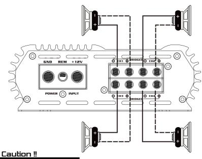
THE USA-SQ442 MINIMUM IMPEDANCE IN THIS CONFIGURATION IS 2 OHMS
