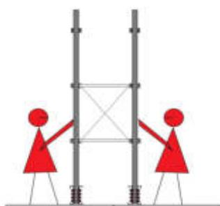
À partir de maintenant, tous les supports suivants seront montés. La disposition des entretoises dépend de la hauteur et est précisée dans les pages suivantes. Cette disposition doit être scrupuleusement respectée, car les entretoises déterminent l'espacement des différents supports et les efforts latéraux et les longueurs de flambement ont été calculés en conséquence.
