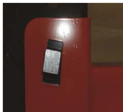
Un léger coup de marteau sur le bras permet d'établir la connexion. En soulevant le bras et en frappant légèrement le bras par le bas, la connexion est relâchée.
