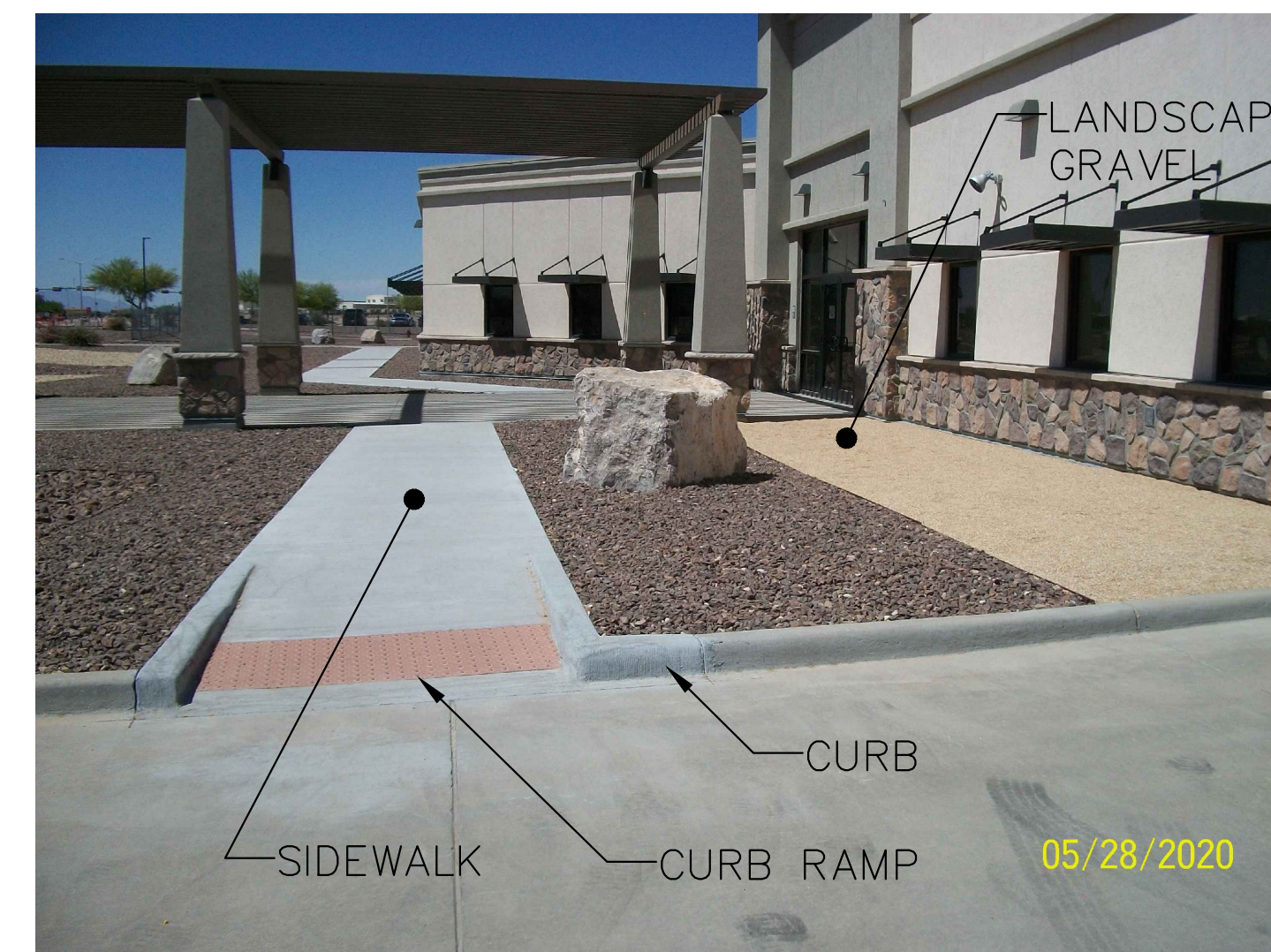
8 SIDEWALK – BUILDING 20709 SCALE: N.T.S.
