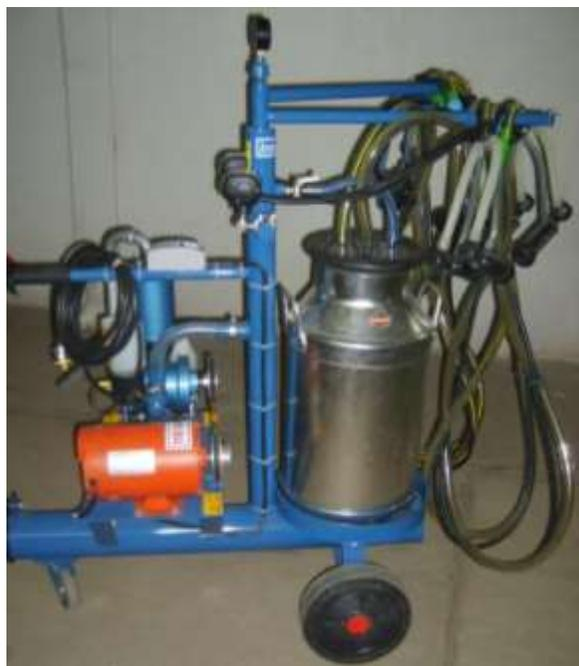
**Figura 3.** Máquina ordeñadora portátil con motor eléctrico (Héctor Gabriel Orozco Castellanos; Ocotlán, Jal., 2010)
