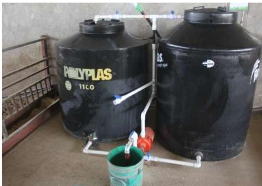
**Figura 2. Diseño del fermentador**
