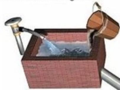
2. Dentro del biodigestor la acción de las bacterias descomponen los desechos transformándolo en gas metano y fertilizante
