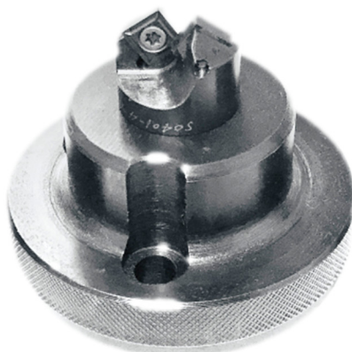
小徑螺絲倒角加工
