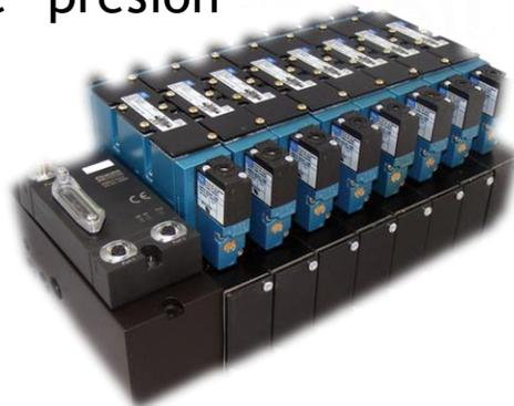
Válvulas MAC Es el fabricante Norteamericano más grande de válvulas neumáticas, se caracterizan por su alta durabilidad y velocidad de conmutación. Sus productos incluyen: válvulas de 3,4 y 5 vías de acción directa, servo pilotada, con operador mecánico y de aire remoto, así como los controladores de presión proporcional.
