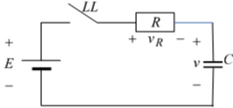
crece con el tiempo asintóticamente ( $t \rightarrow \infty$ ) hasta  $E$  mientras que  $i(t)$  tiende a 0 Ampere desde  $i(0) = E/R$ . La resistencia  $R$  se mide en Ohm ( $\Omega$ ) y  $C$  en Faradios.
