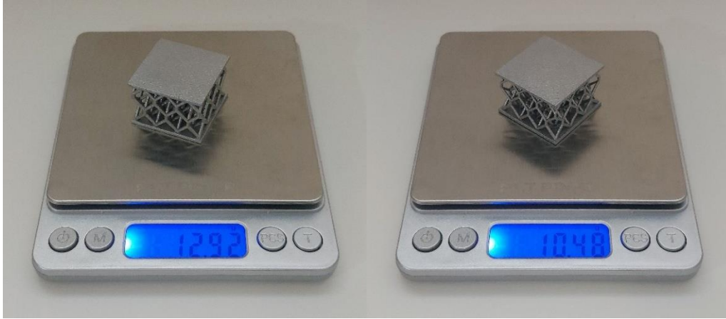
Resim 6.8. Üretilen Deneysel ve Deneysel Gradyan kafes yapılı ısı emicinin ağırlık ölçümü.
