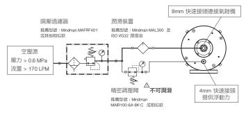
2. 檢查氣銼機的機械原點(\*1),在氣銼機靜止的狀態下給予浮動氣源0.1 MPa 的壓力。確認氣銼機可以回到機械原點,如同下圖所示。如果氣銼機沒有歸位或不在機械原點上,請聯絡您的供應商。
