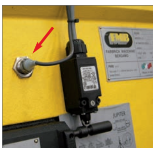
SENS Sensore rotazione nastro Blade rotation sensor Contrôle de defilement du ruban par detecteur
