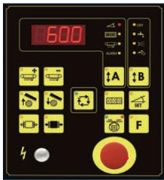
VAT Visualizzatore angolo di taglio. Cutting angle display. Visualisation de l'angle de coupe.
