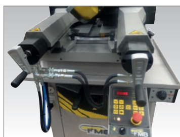
DMI Doppia morsa idraulica - tagli a 0°. Hydraulic double vice - cut at 0°. Double étau hydraulique - coupes 0°.
