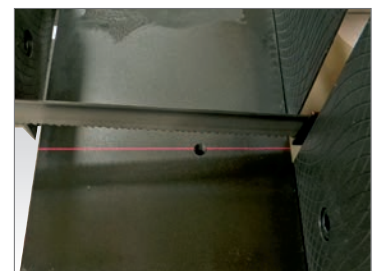
LX Illuminazione linea di taglio con laser. Laser lighting for cutting line. Projection de la ligne coupe par laser.
