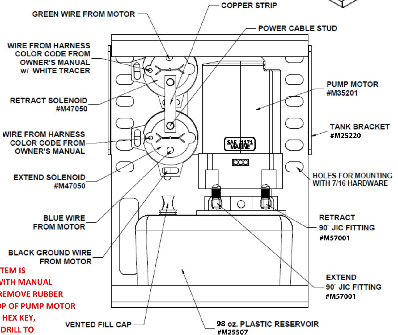
**IF YOUR SYSTEM IS EQUIPPED WITH MANUAL OVERRIDE, REMOVE RUBBER PLUG ON TOP OF PUMP MOTOR AND INSERT HEX KEY, TURN WITH DRILL TO OPERATE JACK UP/DOWN**
