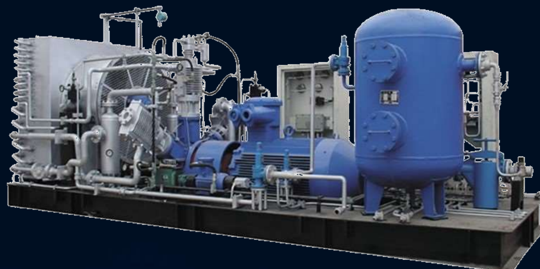
Sistema de filtrado y compresor montado en patín
