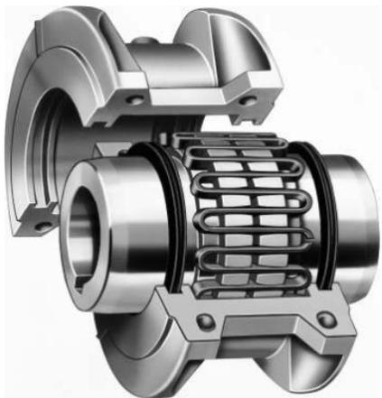
Os acoplamentos de grades elásticas atendem à grande maioria das aplicações industriais. São torcionalmente flexíveis e através das grades elásticas se dão a transmissão de torque e a compensação de desalinhamentos angulares, axiais e paralelos existentes entre os eixos conectados. Absorvem e reduzem sobrecargas e vibrações em até 70%.
