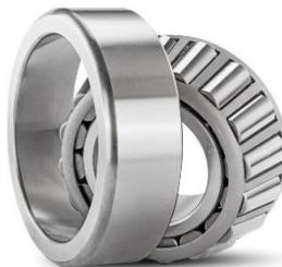
Os rolamentos de rolos cônicos têm pistas de anel interno e externo cônicas e rolos cônicos. Eles são adequados para suportar cargas combinadas, ou seja, cargas axiais e radiais atuando simultaneamente.
