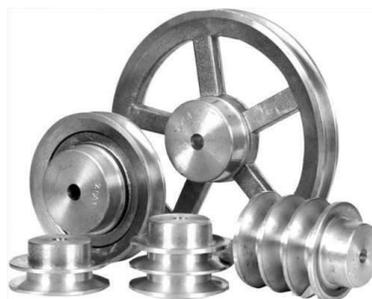
A polia é utilizada, sobretudo para facilitar a elevação de um fardo, tornar mais fácil o esforço de tração ou assegurar uma transmissão de movimento. É constituída de três partes: o eixo, os braços e a calha, existindo polias maciças que não tem braços. O perfil da calha varia de acordo com a correia que pode ser plana, cilíndrica, trapezoidal ou uma corrente.
