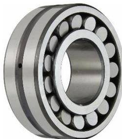
Os rolamentos autocompensadores de rolos são projetados para acomodar cargas radiais pesadas, assim como cargas axiais pesadas em ambas as direções.
